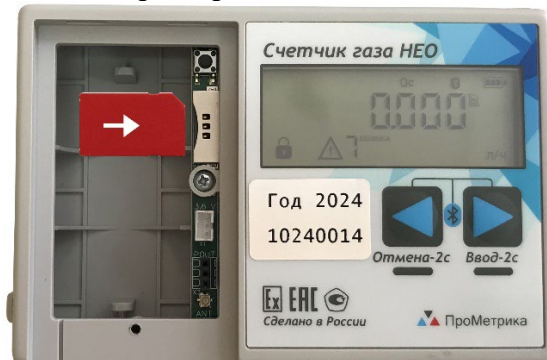
Рисунок 9 – Установка сим-карты в слот
