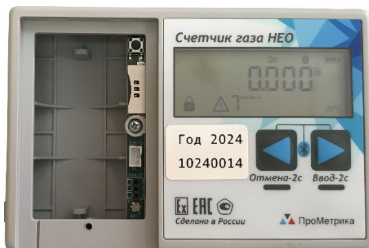
Рисунок 8 – Батарейный отсек со снятым сменным элементом питания
